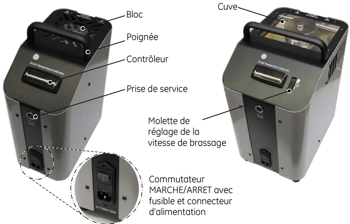
La **partie arrière du boîtier** contient un bloc métallique/bain liquide présentant un trou, accessible par le haut, pour le dispositif de fixation de l'éprouvette.
